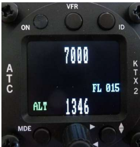
Pas de capteur WOW installé
