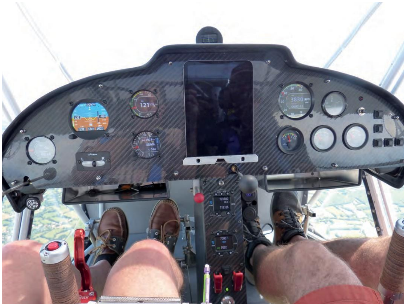
Instruments de vol à gauche, indicateurs moteur à droite, radio, transpondeur et allumages/démarrageur sur la console centrale : tout tombe bien sous les yeux et sous la main.
