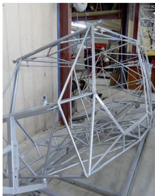
Le treillis soudé qui constitue l'ossature du fuselage est de belle facture : sur la qualité de l'acier, la propreté des soudures et le soin apporté à la peinture, rien à redire.
